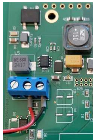
Abbildung 10: Anschluss Gehäuseschutzschalter auf der Platine
