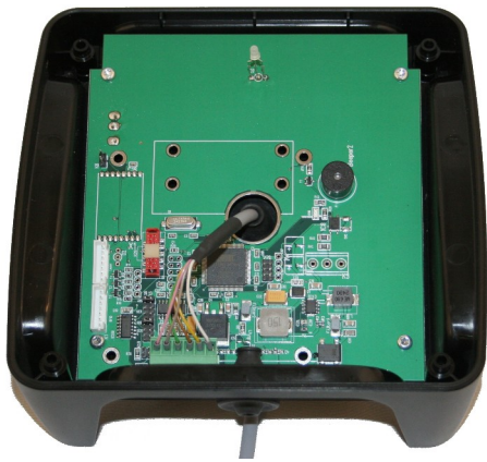
Abbildung 4: neuer RFID-Reader mit durchgeführten Kabel
