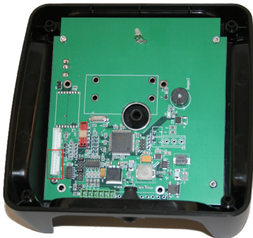
Abbildung 6: RFID-Buchse auf der Platine
