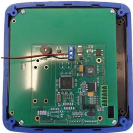
Abbildung 9: Platine auf der Gehäusefront befestigt
