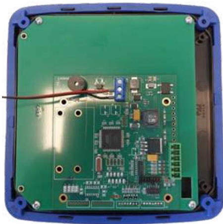
Abbildung 9: Platine auf der Gehäusefront befestigt
