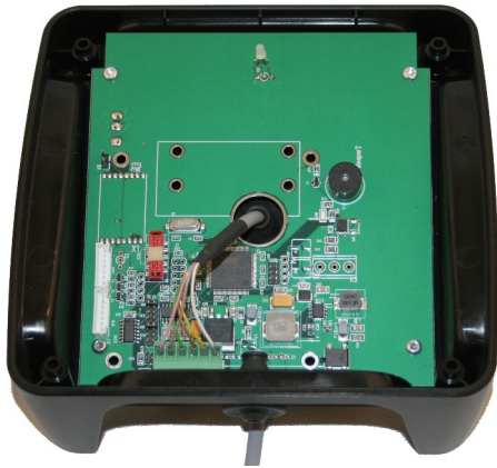
Abbildung 4: neuer RFID-Reader mit durchgeführten Kabel
