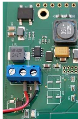
Abbildung 10: Anschluss Gehäuseschutzschalter auf der Platine
